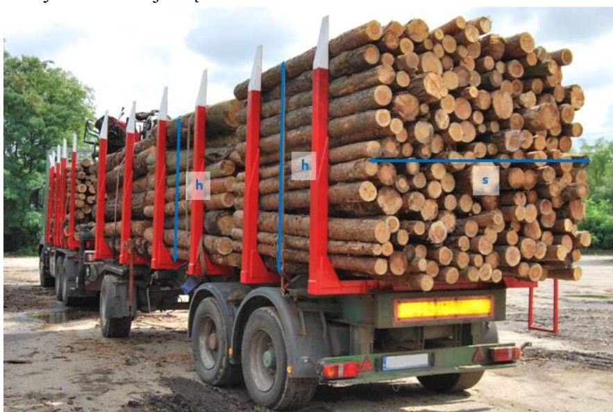
Ryc. 19. Pomiar kontrolny drewna na pojeździe wywozowym
